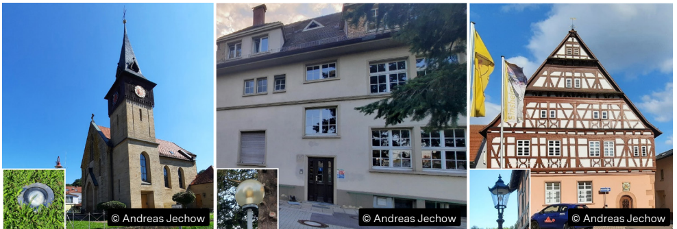
Abbildung 6: Versuchsstandorte mit den ursprünglichen Leuchten und durchgeführte Maßnahmen (v. l. n. r.): kath. Kirche Neckarbischofsheim-Untergimpfern (Abschaltung der Fassadenbeleuchtung), LTZ Rheinstetten (Umrüstung der Kugelleuchten: LED mit „dark sky“ Lichtlenkung, Abdeckung nach oben sowie Veränderung der Farbtemperatur), Rathaus Sinsheim-Eschelbach (Umrüstung s. u.)
