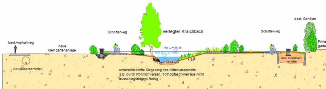
Abb. 4.1: Regelprofil Ausbau km 0+350
