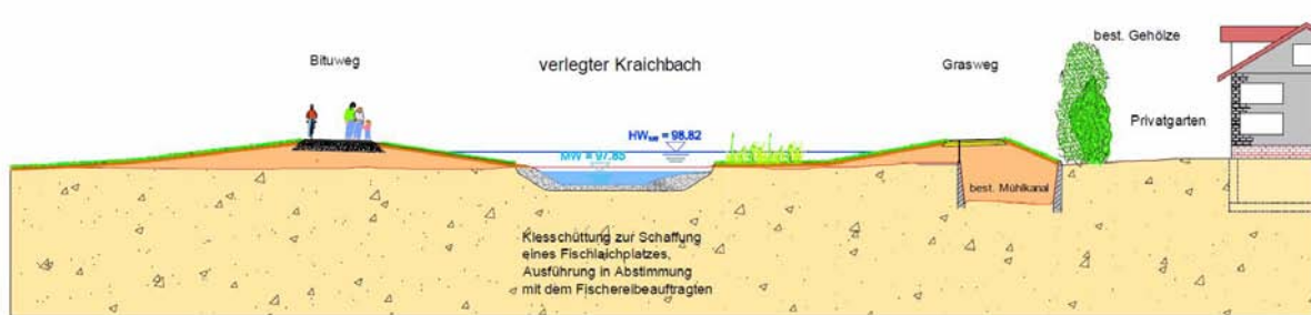
Abb. 4.4: Regelprofil für den Ausbauabschnitt 3 (Bau km 0+625)
