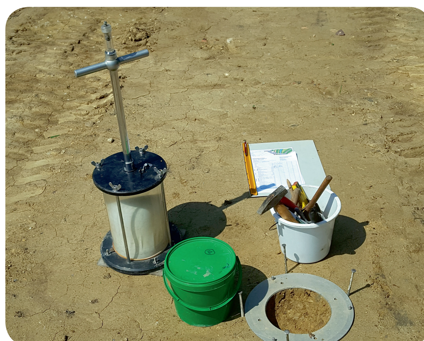
Abb. 1: Mit dem Densitometer wird die Dichte von Böden bestimmt (Foto: Ingenieurgesellschaft Kärcher mbH)
