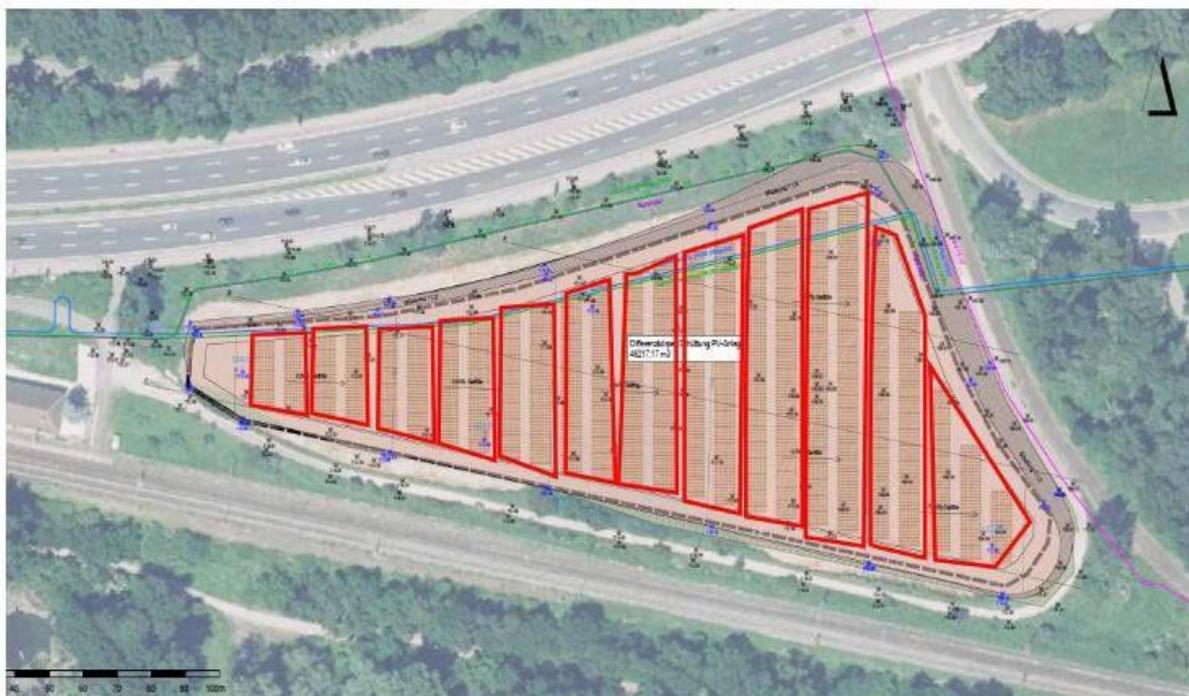
Abbildung 9 Mögliche Lage der Bodenplatten für eine "Schwimmende Gründung" (Quelle: ASTOC, 2023).
