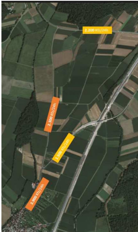
Abbildung 4: Verkehrszahlen DTV gemäß Verkehrsmonitoring 2019
