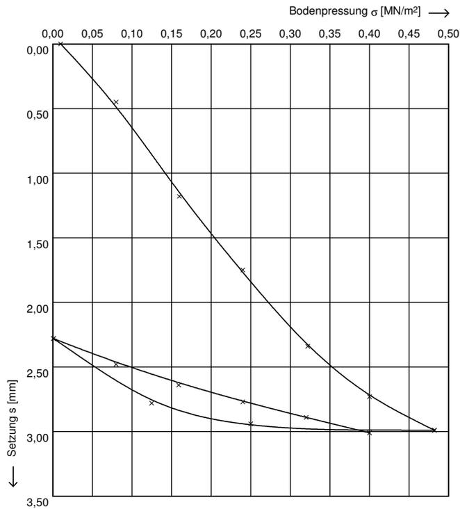
Druckplatte: D = 300,00 mm
