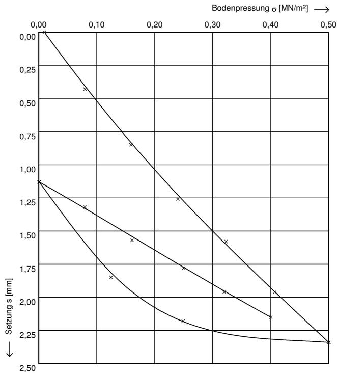
Druckplatte: D = 300,00 mm
