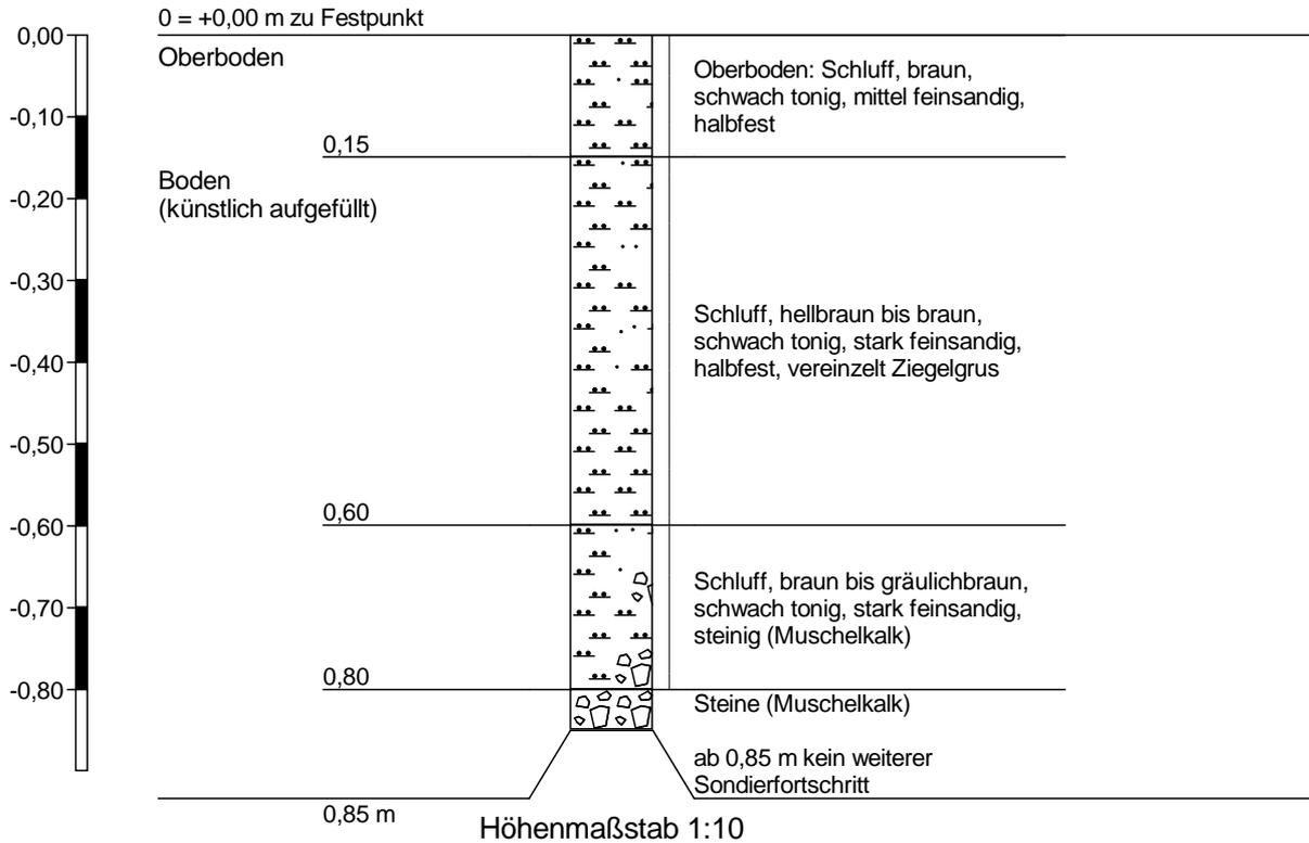
Rammkernsondierung 11 / Böschungsfuß Straßendamm
