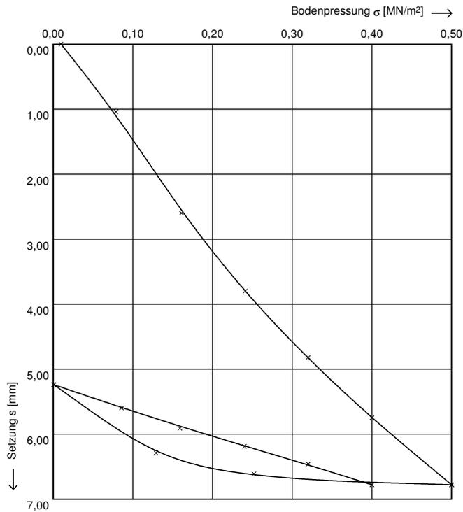
Druckplatte: D = 300,00 mm
