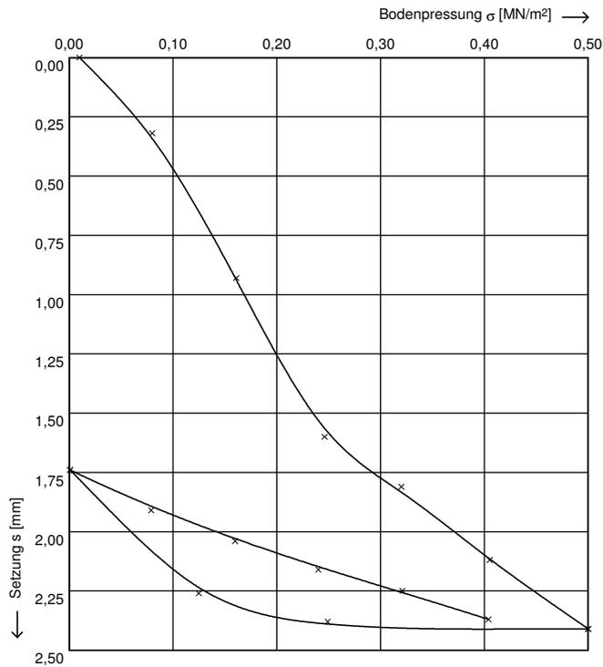
Druckplatte: D = 300,00 mm
