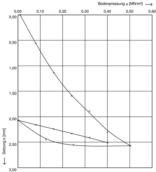
Druckplatte: D = 300,00 mm
