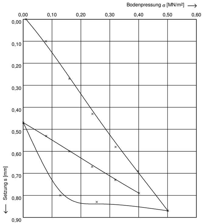
Druckplatte: D = 300,00 mm
